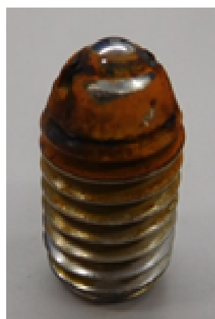
塩水噴霧試験 縦置き XM-7
